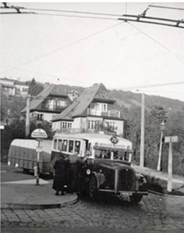
Buslinie 20 mit Leuchtgasanhänger während des Zweiten Weltkriegs in der Umkehrschleife in der Hameaustraße. Die Oberleitung für den Probetrieb des Obusses ist schon vorhanden. Quelle: Wiener Linien
